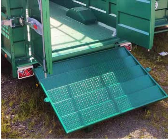
Conçu avec 5 marches antidérapantes en tôle larmée et assisté par 2 vérins à gaz le rendant extrêmement facile à manipuler. De par sa longueur de 1,40 m, il offre une faible pente pour l'accès des bovins. Fabriqué sur la base d'un châssis robuste en rectangle de 80x40 mm. Double verrous latéraux sécurisés par axes et goupilles en position fermée.
