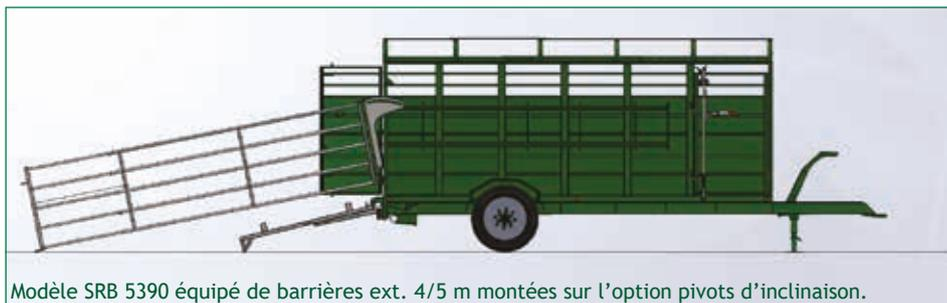
Modèle SRB 5390 équipé de barrières ext. 4/5 m montées sur l'option pivots d'inclinaison.
