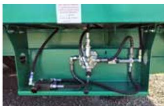
Commande hydraulique arrière gauche protégée dans un caisson avec réglage de débit hydraulique
