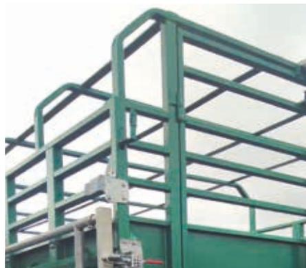
Réhausse de caisse et portes arrière pour chevaux. Passage utile Haut. 2,23 m au lieu de 1.79 m en standard
