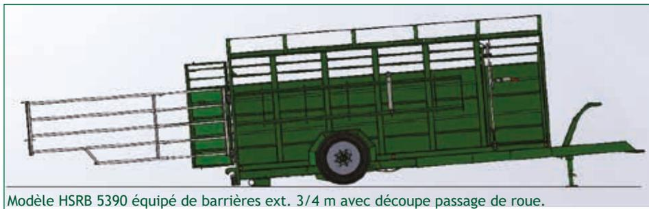
Modèle HSRB 5390 équipé de barrières ext. 3/4 m avec découpe passage de roue.
