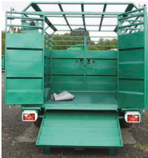
Conçu avec 4 marches antidérapantes en tôle larmée et coulissant à l'intérieur des longerons du châssis. De par sa longueur de 1,05 m, il offre une pente modérée pour l'accès des bovins. Fabriqué sur la base d'un châssis en rectangle de 50x30 mm. Double verrous latéraux sécurisés par axes et goupilles en position fermée.
