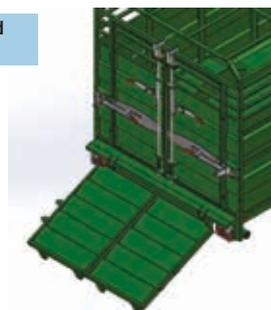
Chaque demi-pont est conçu avec 5 marches antidérapantes en tôle larmée et assisté par 2 vérins à gaz. Demi-pont léger et extrêmement facile à manipuler. De par leurs longueurs de 1,40 m, ils offrent une faible pente pour l'accès des bovins. Fabriqué sur la base d'un châssis robuste en rectangle de 80x40 mm. Un verrou latéral par demi-pont pour les sécuriser par axe et goupille en position fermée.
