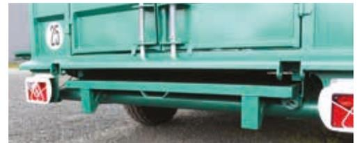
**PONT ARRIÈRE RABATTABLE 2 BATTANTS ASSISTÉ PAR VÉRINS À GAZ - 5 MARCHES - LARGEUR 1,80 M - LONGUEUR 1,40 M**
