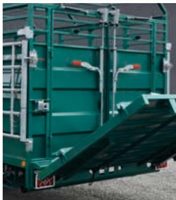
Conçu avec 7 marches antidérapantes en tôle larmée et assisté par 2 vérins hydrauliques. De par sa longueur de 1,90 m, il offre une très faible pente pour l'accès des bovins. Fabriqué sur la base d'un châssis robuste en rectangle de 100x50 mm. Double verrous latéraux sécurisés par axes et goupilles en position fermée.
